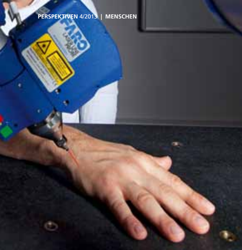
Basis für die Produktion einer Prothese aus dem 3-D-Drucker ist zunächst ein hochpräziser Scan.
