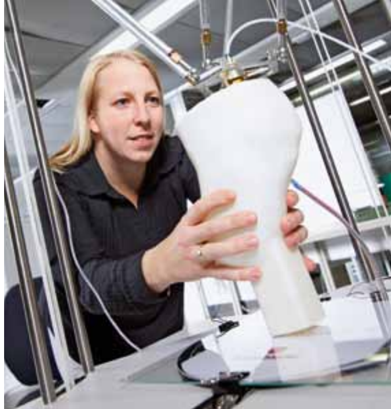
Der „gedruckte“ Prothesenschaft ist fertig. Stefanie Wagner, Auszubildende zur Qualitätsfachfrau, holt den Schaft aus dem 3-D-Drucker.
